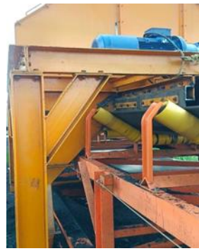
Feb 2025 - Supply & Pemasangan Cutting Sampler & Belt Scale pada BLC 1500 TPH - PT Baturona Adimulya
