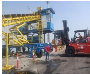
Oct 2025 - New Coal Unloading Conveyor Unit ke-1 Cap. 400 TPH - PT Siam Maspion Terminal, Gresik, Jawa Timur
