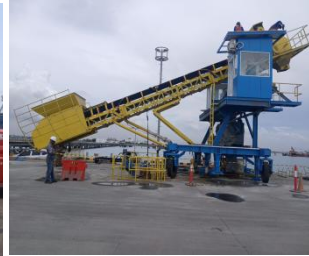
Oct 2025 - New Coal Unloading Conveyor Unit ke-1 Cap. 400 TPH - PT Siam Maspion Terminal, Gresik, Jawa Timur
