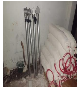
Februari 2015 - Supply Material Sacrificial Magnesium Anode for Pipeline - PT. Perusahaan Gas Negara, Tambak Lorok, Semarang, Jateng
