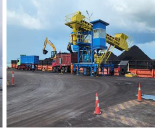
Oct 2025 - New Coal Unloading Conveyor Unit ke-1 Cap. 400 TPH - PT Siam Maspion Terminal, Gresik, Jawa Timur
