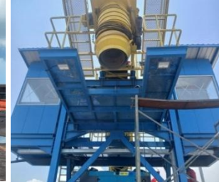
Oct 2025 - New Coal Unloading Conveyor Unit ke-1 Cap. 400 TPH - PT Siam Maspion Terminal, Gresik, Jawa Timur
